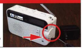
2 電池を入れます(推奨) ※停電時の場合などのために 電池を入れます(推奨) 電池をセットしておくことをおすすめします。
