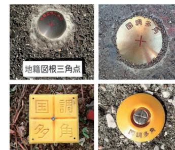
地籍調査により設置された標識(地籍図根三角点、地籍図根多角点など)は、公共測量や登記目的で活用されている大切な基準点です。
