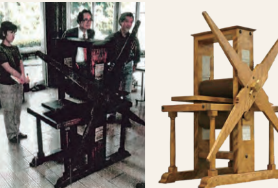
復元されたロール式木製銅版画印刷機
