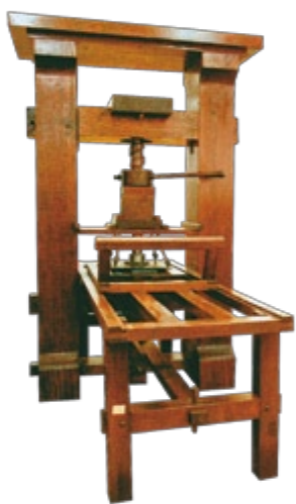
※1 グーテンベルク式活版印刷機とは 1447年、ドイツ人のヨハン・グーテンベルクがぶどう酒のしほり機をヒントに発明した印刷機で、従来の木版印刷から金属活字印刷へ変わった画期的な印刷方式であった。 小池徳久志撮影
