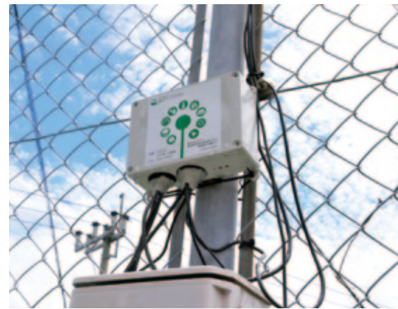
自動的に圃場の環境を計測、記録し、そのデータを離れたところからいつでも確認することができる圃場モニタリングシステム
