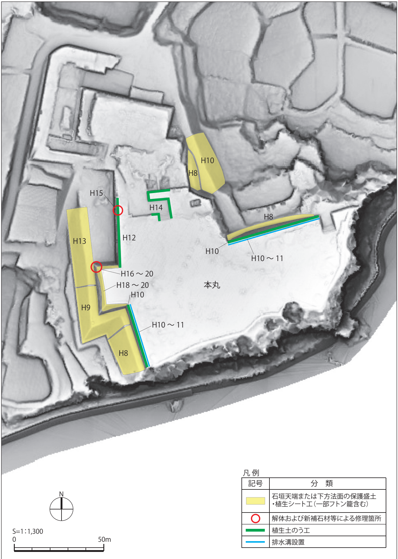
図 4-1 整備実施状況配置図 (1) (石垣保存措置)
