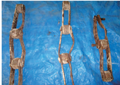
不燃物が詰まり破損した焼却炉の部品
